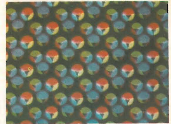
Fig. 29 - Visione ingrandita dei puntini di fosforo dello schermo nel caso di purezza di colori mal regolata.
